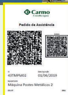
Ce système par la simple lecture d'un QR Code, permet d'envoyer un *reporting* d'une panne avec l'immatriculation de la machine en question, l'identification du problème ainsi que des photos via un téléphone portable.
