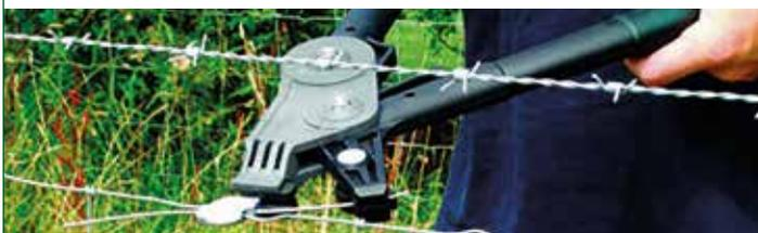
**Instalar e reparar vedações de rede galvanizada com a Gripple Plus**
