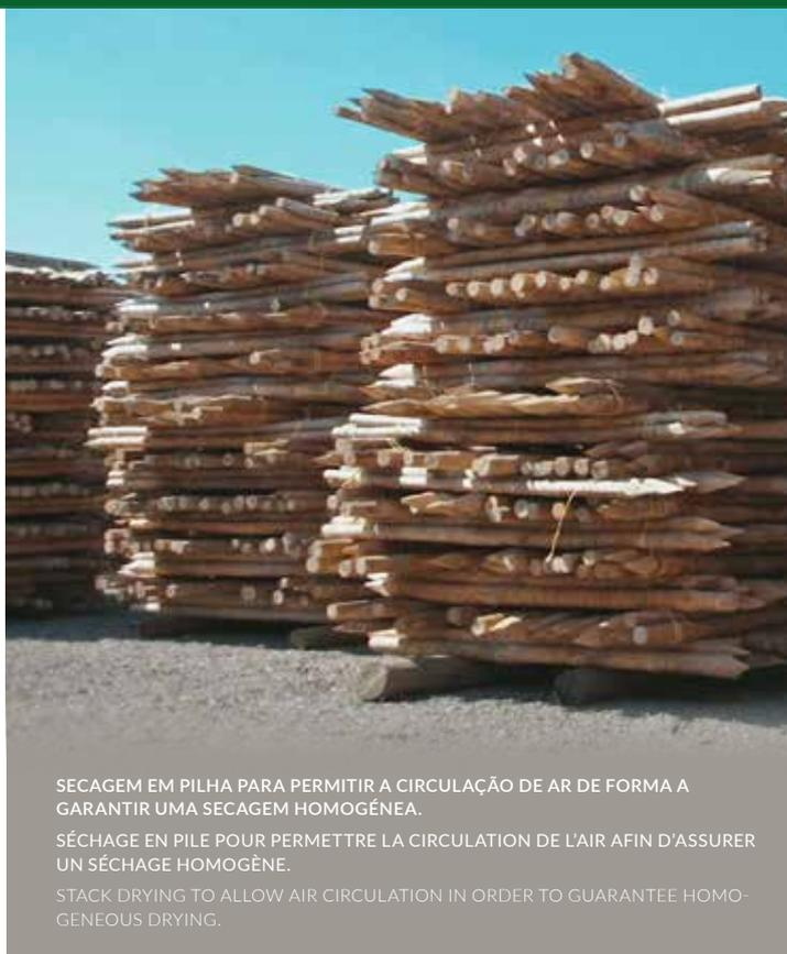
SECAGEM EM PILHA PARA PERMITIR A CIRCULAÇÃO DE AR DE FORMA A GARANTIR UMA SECAGEM HOMOGÊNEA.
