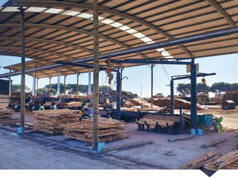
A Carmo Wood remodelou todo o sistema de produção da sua central de postes para agricultura, com a instalação de uma cobertura nova e maior, abrangendo toda a área dos abicadores; novo sistema e mais forte de aspiração das aparas; descascador e máquina de corrigir nós novos para uma maior e melhor produtividade.
