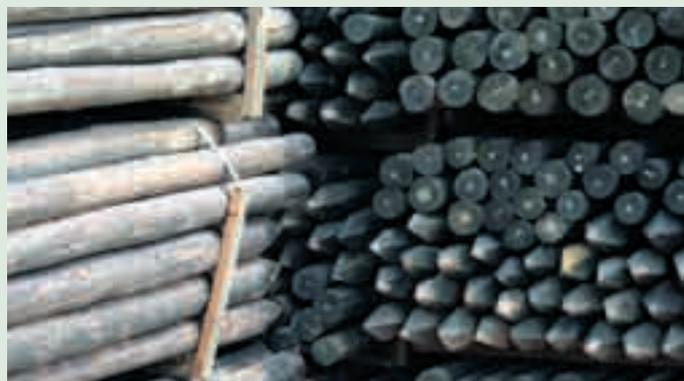
profundidade pelo processo de vácuo e pressão Bethel. Este processo permite o revestimento das paredes celulares com produtos fungicidas e insecticidas, que impedem a progressão dos micélios dos fungos ou o desenvolvimento de larvas de insectos.
