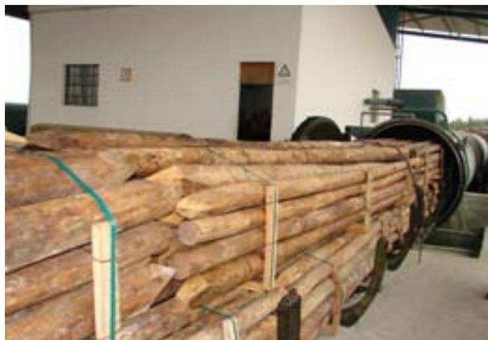
seca é introduzida num autoclave onde se faz um vácuo quase perfeito, retirando o ar de dentro de cada célula de madeira. É então injectado produto líquido contendo “ingredientes” activos insecticidas e fungicidas que por pressão penetram em todo o Borne da madeira. Um controlo de temperaturas e reacções químicas permite a fixação destes produtos no lenho.
