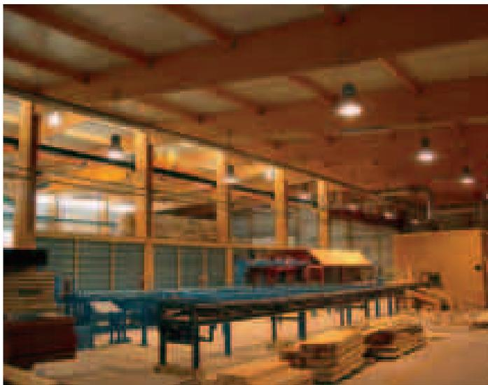
O layout da fábrica foi desenhado para que exista uma fluência das peças sem que voltem duas vezes ao mesmo local. Pórticos e gruas movimentam as peças de grande dimensão.
