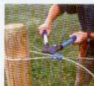
5. Coloque o TENSULATOR na boca do alicate e faça correr o monofilamento por dentro do TENSULATOR até obter a tensão desejada.
